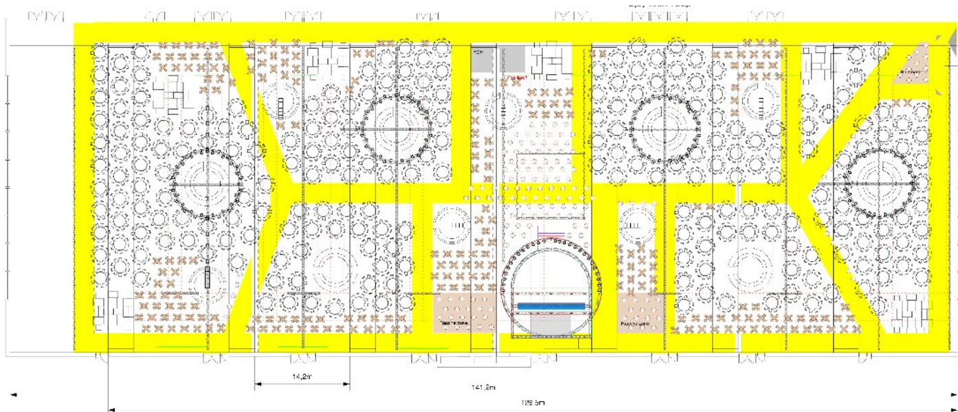
Illustration 3: Bestuhlungs- und Rettungswegeplan. Der Haupteingang ist oben rechts (grauer Pfeil). Links die abgetrennte Staufläche. Man erkennt die vier Rundprojektionsflächen und die Bühne.
